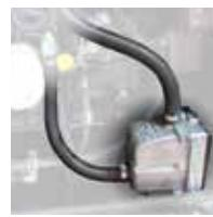
**IT** Il sistema di preriscalo del circuito di raffreddamento del motore mediante resistenza elettrica consente un facile avvio anche a basse temperature.
