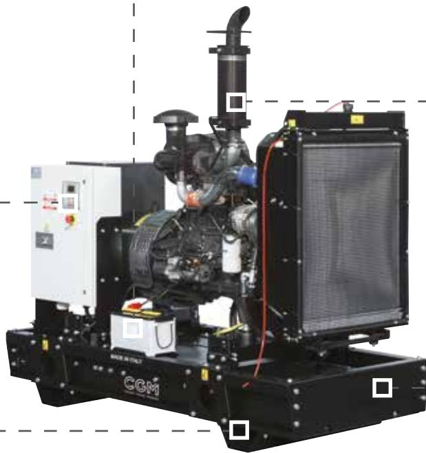
**IT** Basamento per gruppo elettrogeno aperto, realizzato in acciaio strutturale. Quattro zampe di appoggio con fori per il fissaggio al suolo della macchina. Supporti antivibranti in gomma tra motore/alternatore e basamento.
